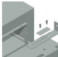
Rys.5. Stopka poziomująca oraz regulowany uchwyt mocujący
